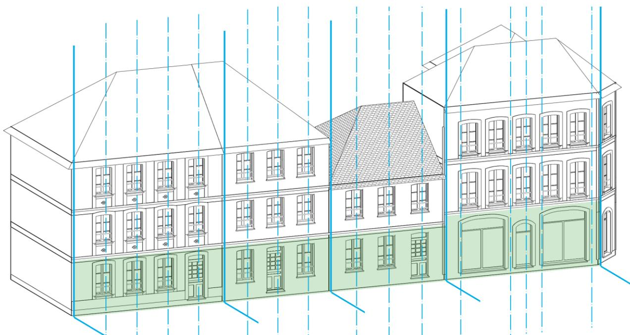
Principes d'implantation des devantures commerciales en RdC, dans le respect du parcellaire et des trames de façade
